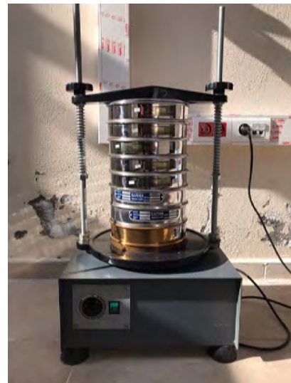
Şekil 7. Fındık kabuklarının elenmesinde kullanılan cihaz ve eleme işleminin görüntüsü
