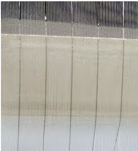
Şekil 5. Güç tutuşur iplikler arasında bariyer oluşturan bazalt
