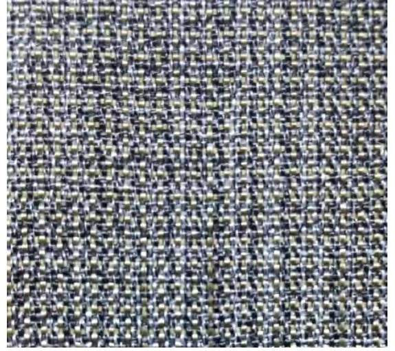
Şekil 6. Güç tutuşur ipliklerle bazalt birleştirilerek yapılan kumaş
