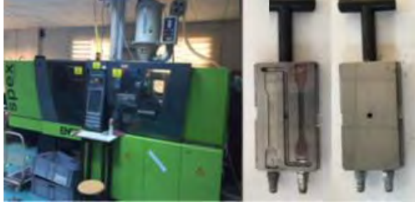
Şekil 11. Karışımların enjeksiyonla kalıplanmasında kullanılan makine ve test numunesi kalıpları
