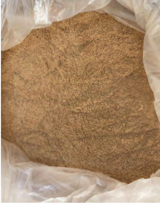
Şekil 8. Eleme işlemi sonrası aynı boyutlarda (>100 mikron) sınıflandırılmış fındık kabuğu
