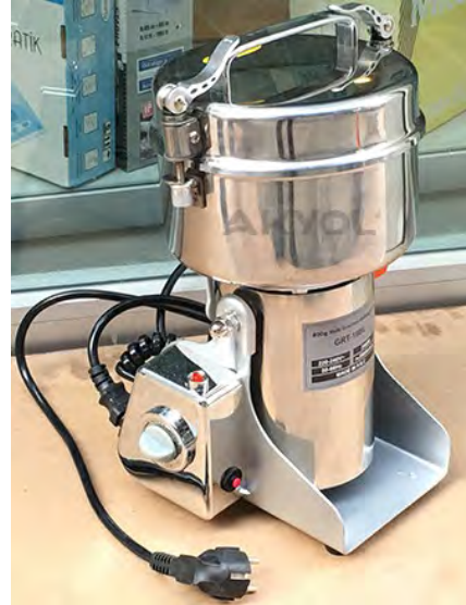
Şekil 6. Fındık kabuklarının öğütülmesinde kullanılan öğütücü değirmen 34
