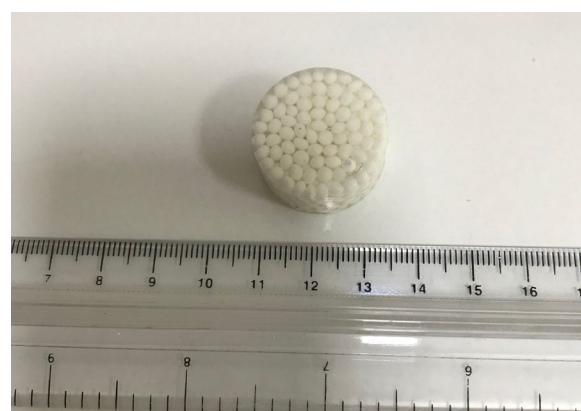
**Şekil 2.** Üretilen alümina küre takviyeli epoksi kompozite ait temsili makroskopik görünüm
