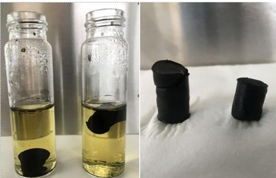
Şekil 1. Elde edilen grafen hidrojel resimleri.
