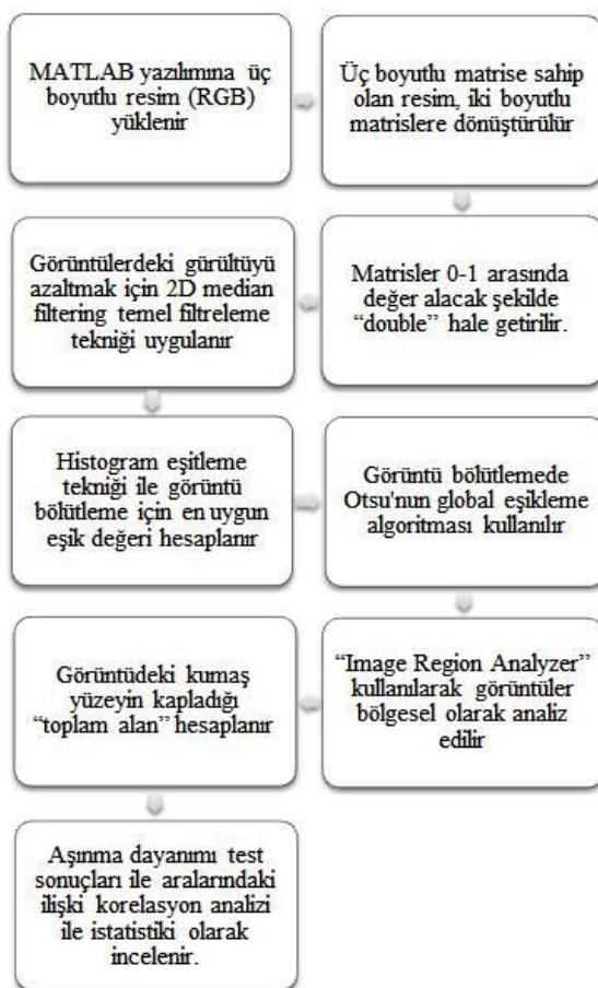
Şekil 1. Takip edilen görüntü işleme adımları
