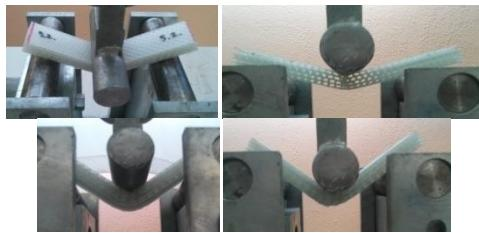
Şekil 1. Uygulanan üç nokta eğilme deneyleri.
