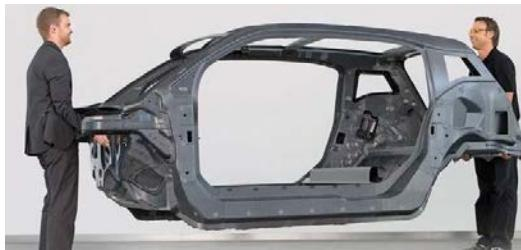
**Şekil 3:** BMW i3 için geliştirilmiş hafif araç gövdesi (SGL Carbon, 2017)
