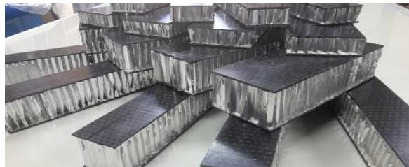
Şekil 1. Deneylerde kullanılan sandviç yapı örnekleri
