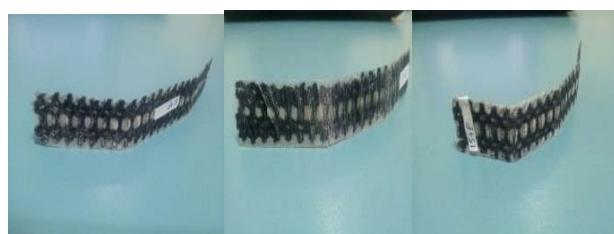
Şekil 11. Poliester esaslı tavuk tüyü takviyeli kompozit malzemelerin eğime testinden sonra elde edilen görüntüler
