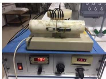
Şekil 4. Isı geçirgenlik test cihazı
