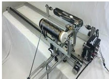
Şekil 1. Elyaf sarma tekniği.
