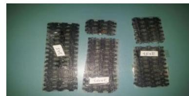
Şekil 3. Epoksi esaslı tavuk tüyü takviyeli kompozitlere çekme testi uygulanıktan sonraki görüntüler
