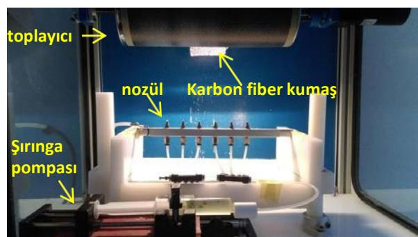
Şekil 1. Elektroegirme sistemi
