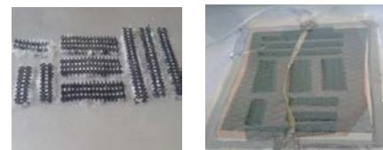
Şekil 1. vakum infüzyon yöntemiyle üretilen kompozitler
