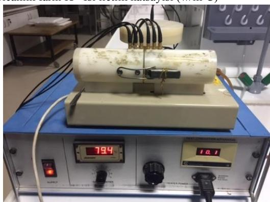
Şekil 3. Isı Geçirgenlik Test Cihazı
