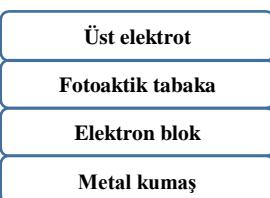
**Şekil 1.** Metal allığı üzerinde elde edilmiş fotovoltaik yapının şematik gösterimi.
