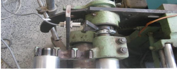
Şekil 1. Arka köprüye takılan yer değiştirme sensörü
