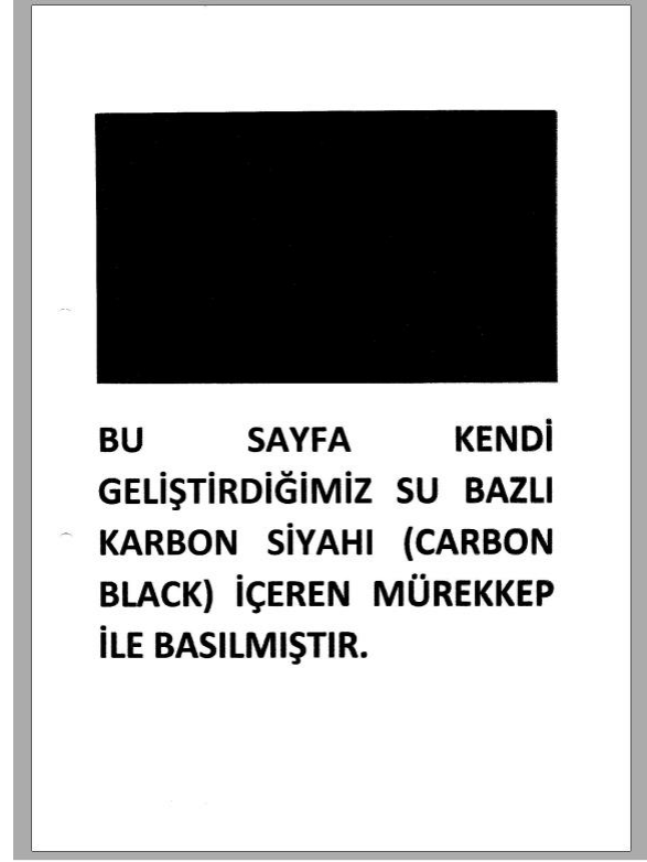
Şekil 6 : Üretilen Karbon Siyahı Esaslı Mürekkebin Ofis Tipi İnkjet Yazıcıda Denenmesi
