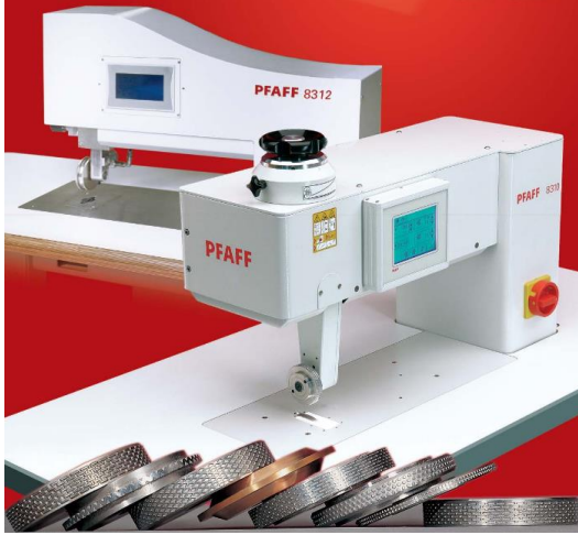
Şekil 12 : Ultrasonik Dikiş makinesi ve roller örnekleri 4
