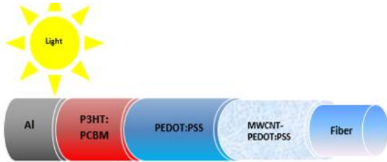
Sekil 1. Organik güneş pilinin sematik gösterimi
