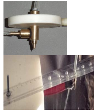
Şekil 2. A: Eş eksenli düze B:Farklı konumdan polimer besleme/mesafe ayarlama aparatı
