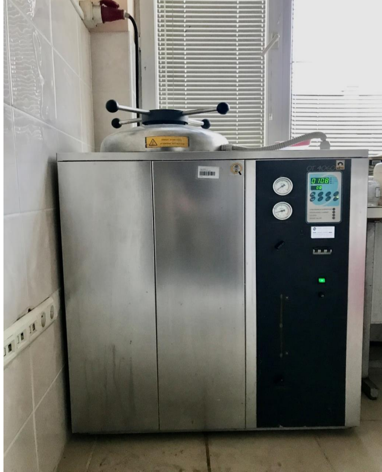
Nüve OT 4060 Dik Tip Buharlı Sterilizatör (Otoklav)
