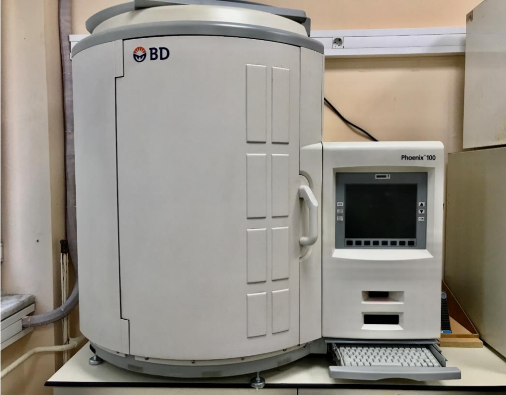
BD > Phoenix 100 Otomatik, Bakteri İdentifikasyon ve Antibiyogram Hassasiyet Testi Cihazı
