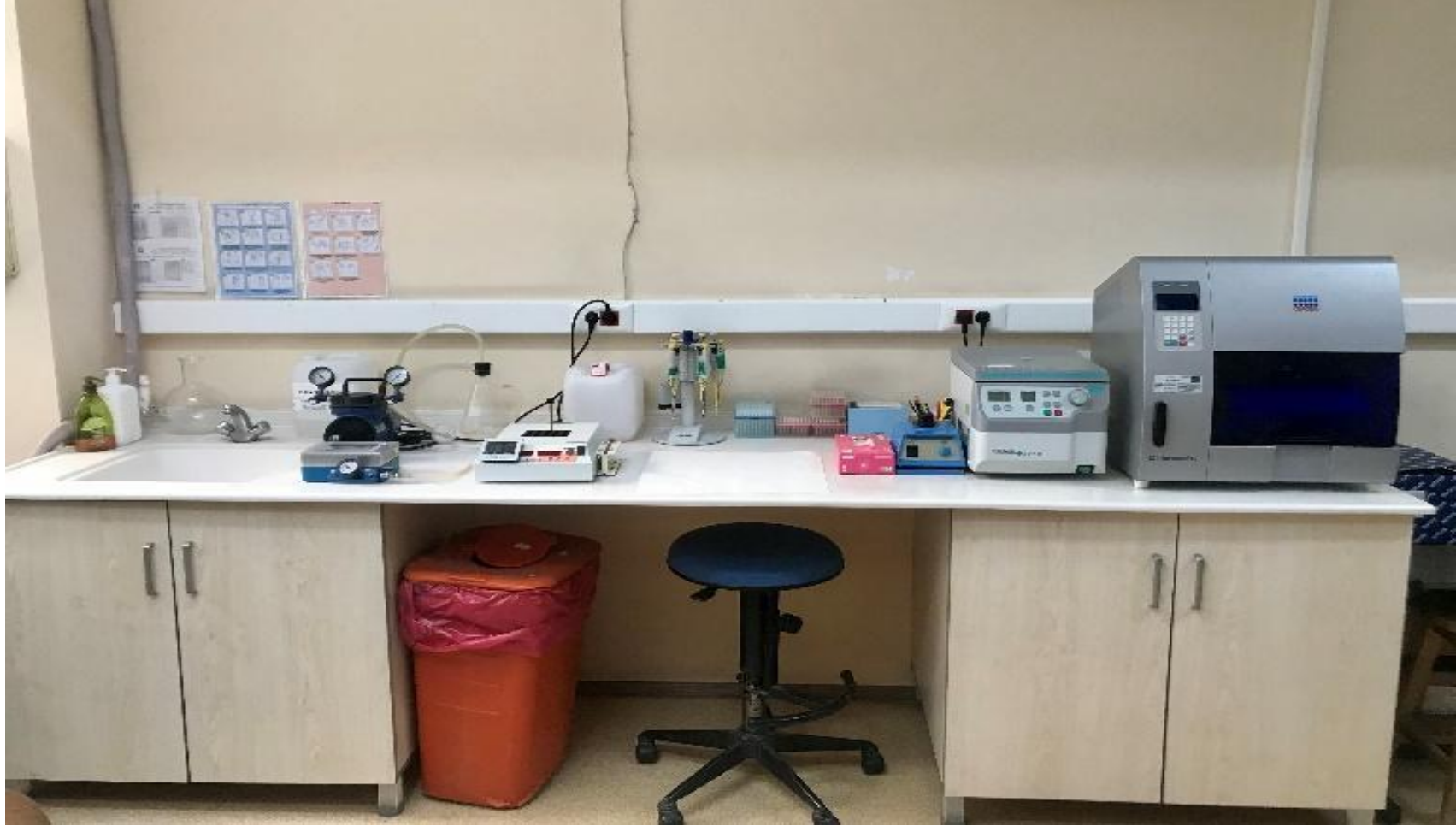
DNA izolasyon cihazı (Qıagen, EZ1 Advanced XL), Mini santrifüj ( Hermle, Z216M), ısı bloğu
