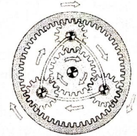
Güneş dişli, iç dişli ve planet taşıyıcı aynı devirde dönüyor
