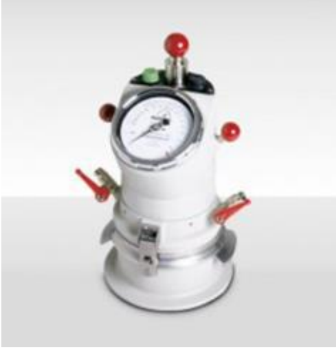
Hava ölçer TS EN 413-2, 459-2, 1015-7, EN196-1, 11,1744-113454-2; ASTM C109,C349; BS 3892-1,4551-1
