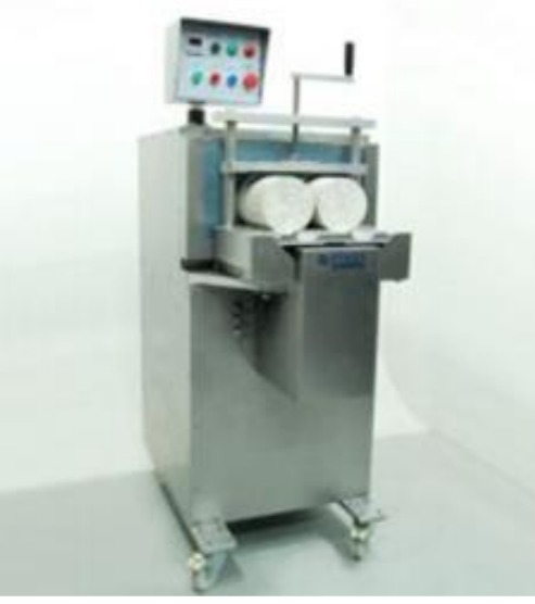
Tam Otomatik Numune Yüzey Aşındırma Cihazı
