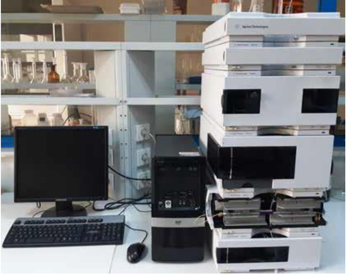
Yüksek Performanslı Sıvı Kromatografisi (HPLC) (Agilent Technologies 1200 Series, DAD ve Floresans detektör)
