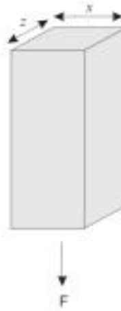
Şekil 6 Dikdörtgen kesitli bir malzemenin çeki gerilmesi
