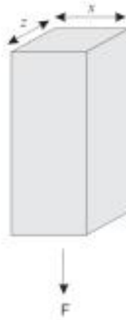
Şekil 6 Dikdörtgen kesitli bir malzemenin çeki gerilmesi
