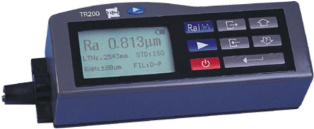
Şekil 10. İğneli (stylus) portatif profilometre
