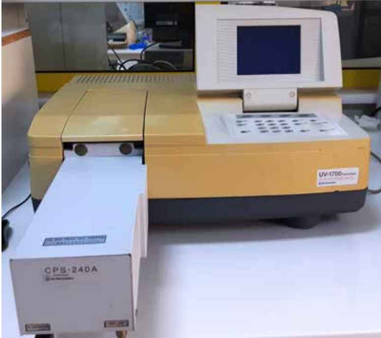
Sıcaklık Kontrollü UV-Vis Spektrofotometresi (Shimadzu, UV-1700)
