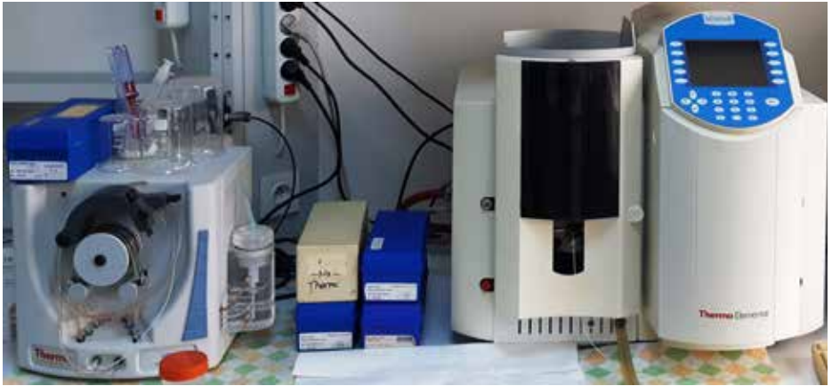
Alevli Atomik Absorpsiyon Spektrofotometresi (AAAS) (Thermo Elemental, HG-100)
