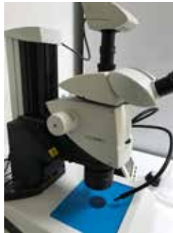
Stereo Mikroskop (LEICA M205C)
