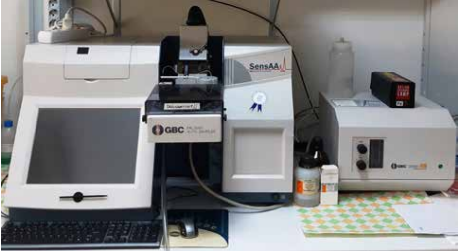
Grafit Fırınılı Atomik Absorpsiyon Spektrofotometresi (GFAAS) (GBC)
