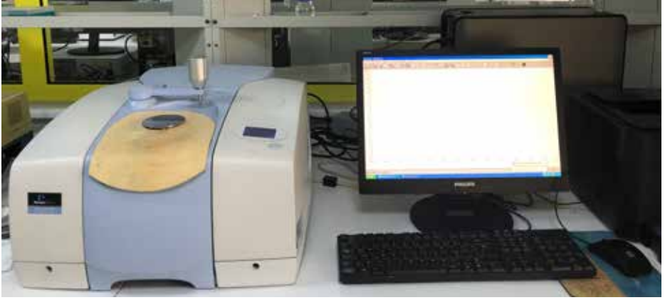
Infrared Spektrofotometresi (IR) (Pelkin Elmer, Spectrum 100)
