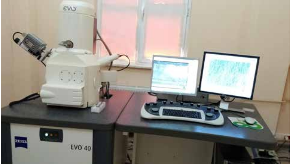
Taramalı Elektron Mikroskobu (SEM-EDX) (ZEISS EVO 40)
