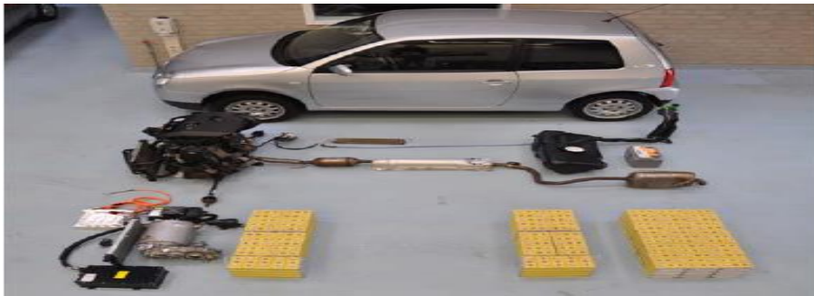
Şekil 3. Lupo 3L model arabaya ait dizel ve elektrik güç aktarma sistemleri (Besselinck ve ark., 2010)
