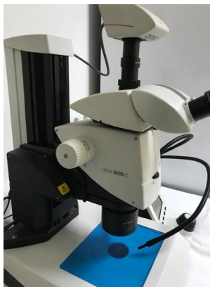
Stereo Mikroskop (LEICA M205C)
