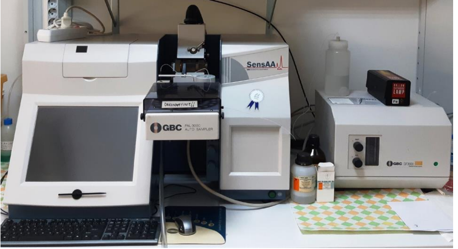
Grafit Fırınlı Atomik Absorpsiyon Spektrofotometresi (GFAAS) (GBC)
