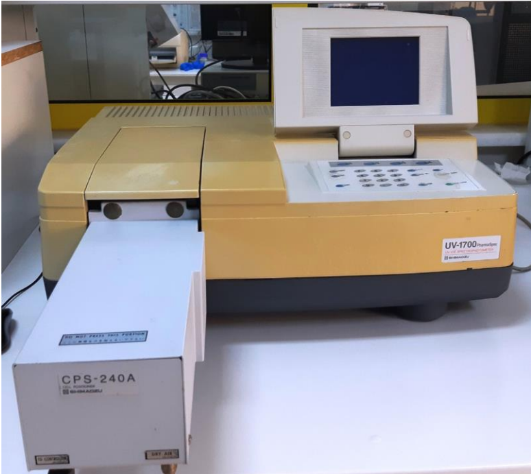
Sıcaklık Kontrollü UV-Vis Spektrofotometresi (Shimadzu, UV-1700)
