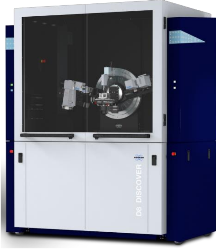
X-Işını Kırınım Cihazı (Bruker, D8 Discover)
