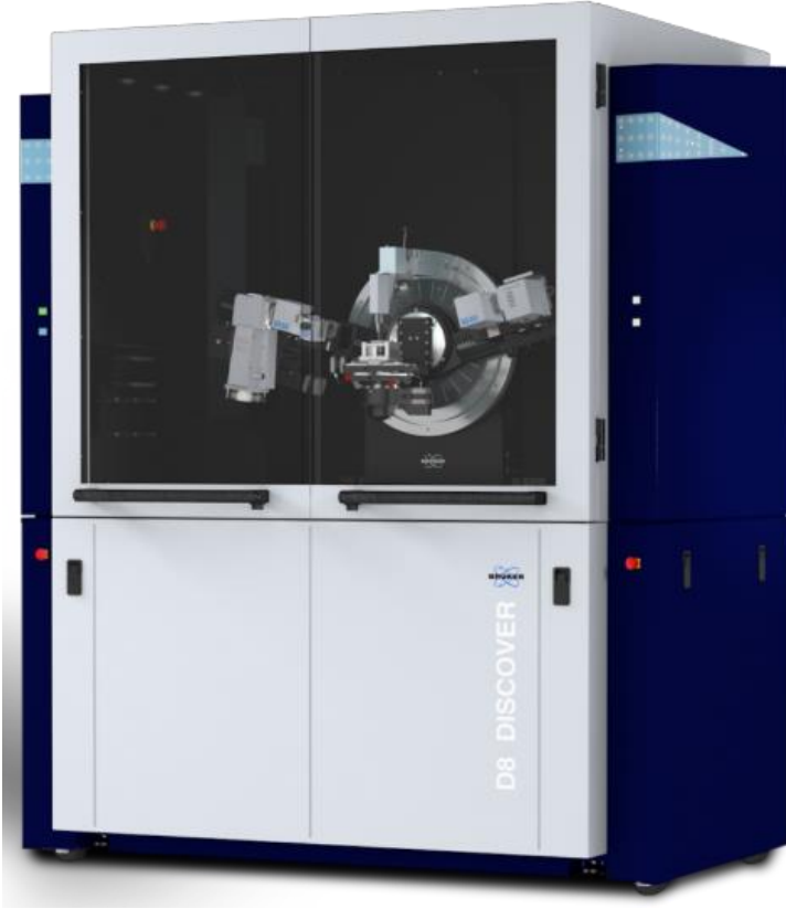
X-Işını Kırınım Cihazı (Bruker, D8 Discover)
