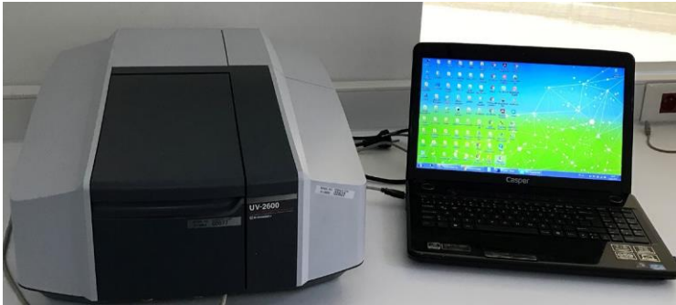
UV-Vis Spektrofotometre (Shimadzu 2600)
