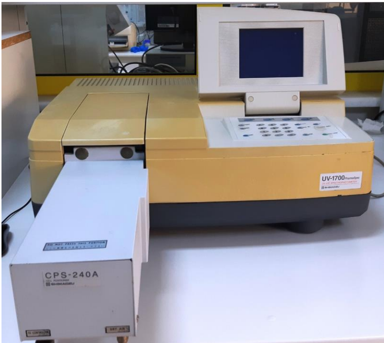
Sıcaklık Kontrollü UV-Vis Spektrofotometresi (Shimadzu, UV-1700)
