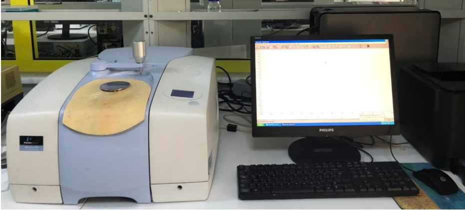
Infrared Spektrofotometresi (IR) (Pelkin Elmer, Spectrum 100)
