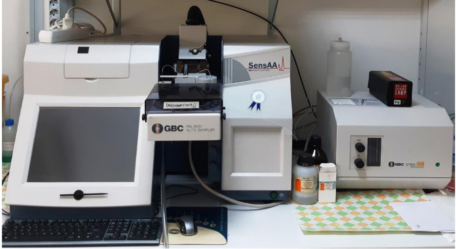
Grafit Fırınılı Atomik Absorpsiyon Spektrofotometresi (GFAAS) (GBC)
