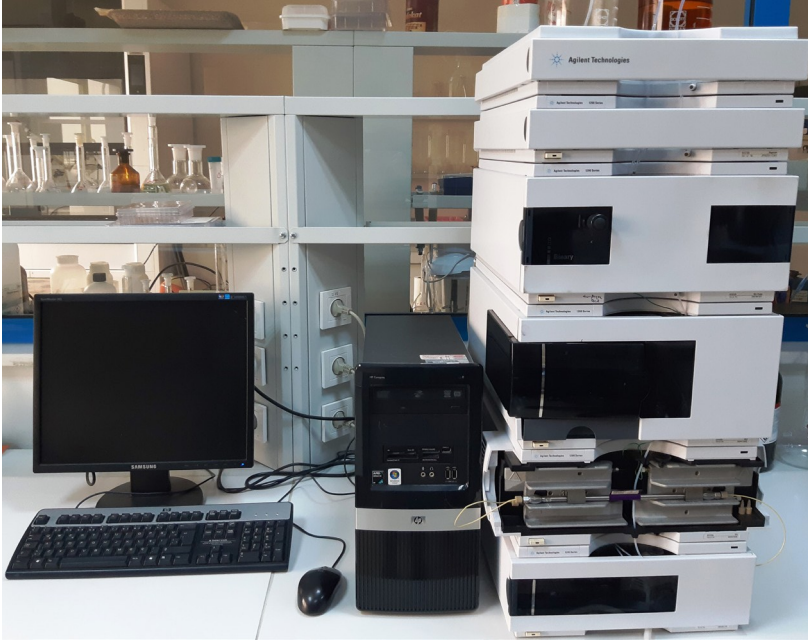
Yüksek Performanslı Sıvı Kromatografisi (HPLC) (Agilent Technologies 1200 Series, DAD ve Floresans dedektör)
