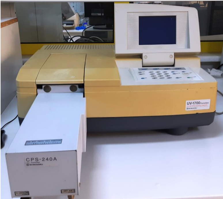
Sıcaklık Kontrollü UV-Vis Spektrofotometresi (Shimadzu, UV-1700)
