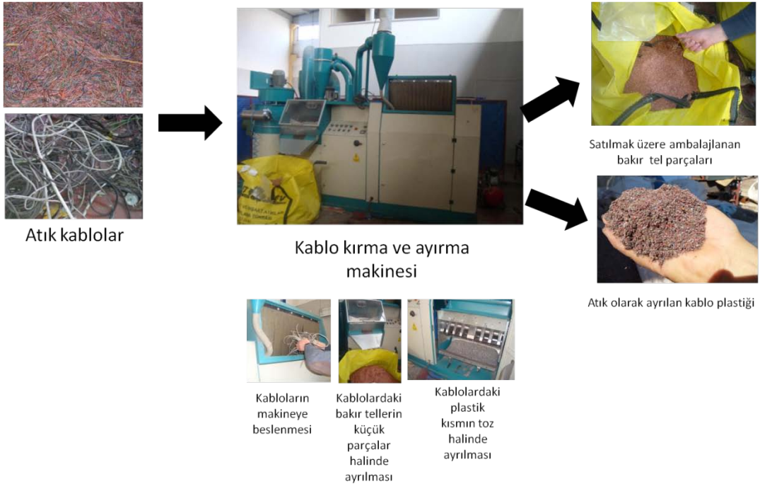
Şekil 16. Atık kablolardan metal geri kazanımı
