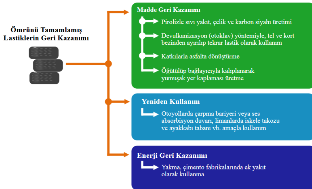
Şekil 20. Ömrünü tamamlamış lastiklerin geri kazanımı için uygulanan yöntemler
