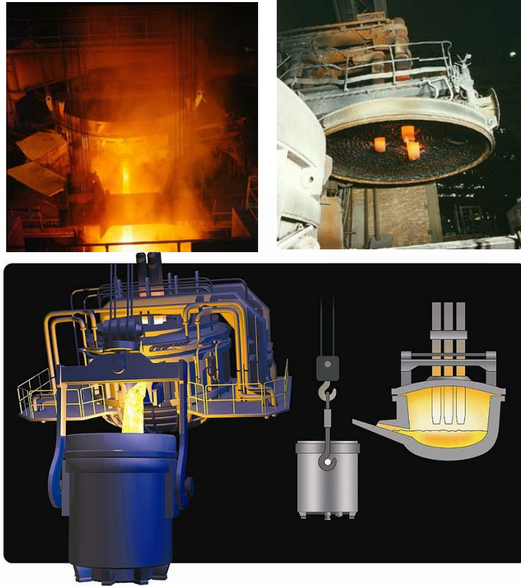
Şekil 27. Elektrik ark ocağı görüntüleri
