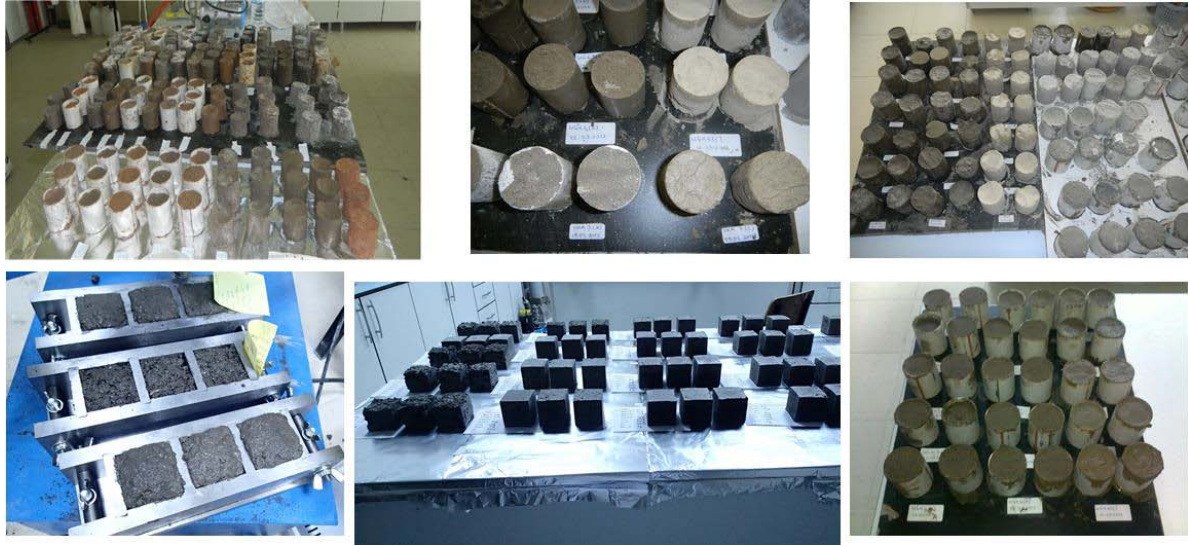
Şekil 5.12. Laboratuvar ortamında farklı atıklarla hazırlanmış K/K örnekleri
