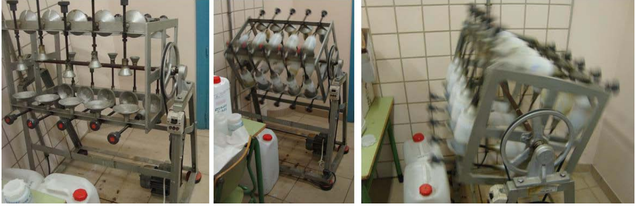
Şekil 5.13. TCLP Testinde Kullanılan Döner Özütleme Cihazı
