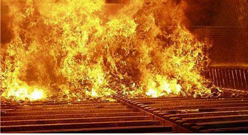
Şekil 6. Yakma ızgaraları üzerinde gerçekleşen bir atık yakma olayı
