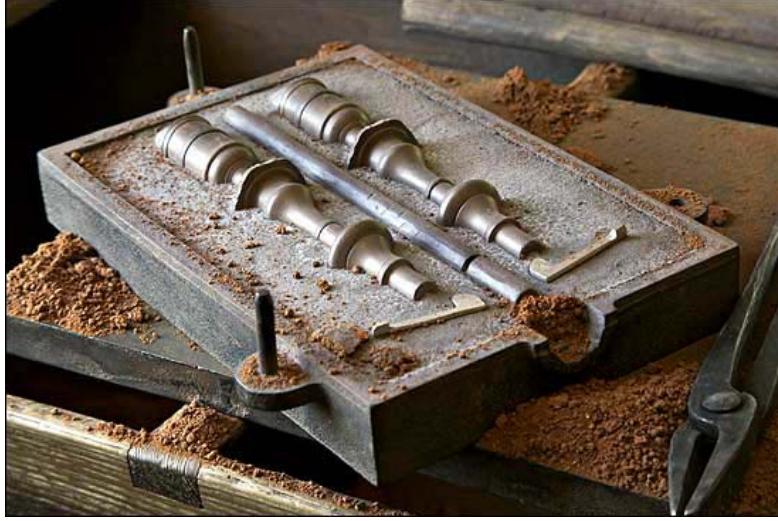
Şekil 18. Döküm endüstrisinde kullanılan kumdan kalıplar
