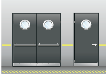
Şekil 5.4. Laboratuvar kapısında görüş penceresi
