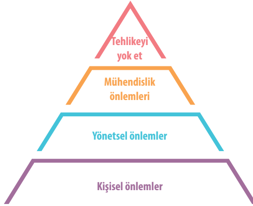
Şekil 2.5. Tehlike ve riskin kontrolü
