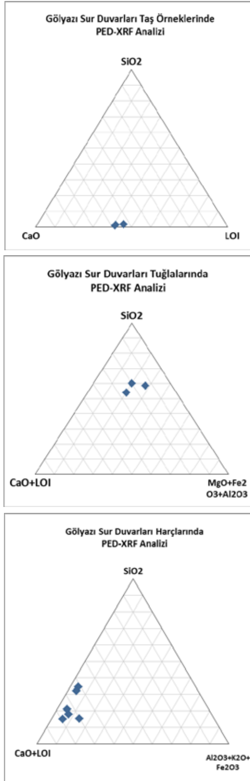
Görsel 14. Gölyazı Sur Duvarları (a) taş, (b) tuğla ve (c) harç örneklerinde PED-XRF analizi sonuçları gruplandırmaları (Triangular Plotting)
